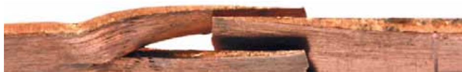
17. Zijaanzicht van de tot de helft van de originele dikte gehamerde oude en nieuwe koperplaat.
